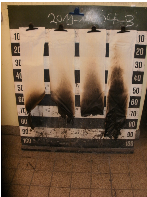
Aussehen der Probe C nach dem Brandschachtversuch
