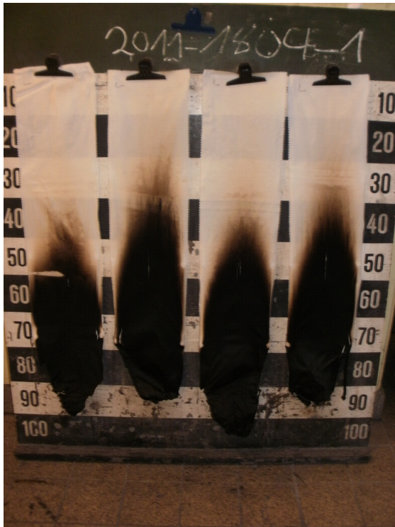
Aussehen der Probe A nach dem Brandschachtversuch
