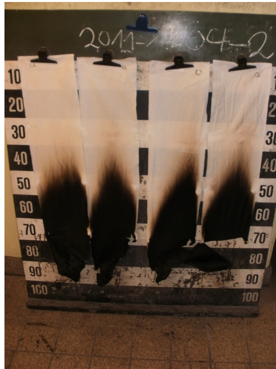
Aussehen der Probe B nach dem Brandschachtversuch
